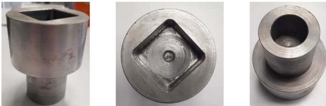
Nakładka— adapter (młot sds max) do wbijania konstrukcji.
