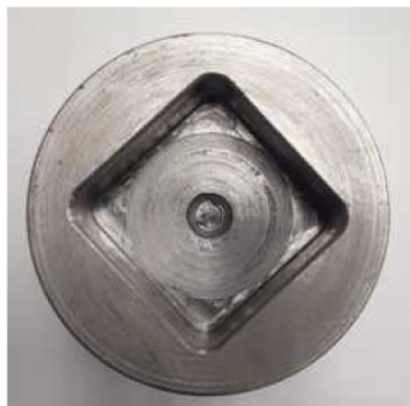
Nakładka— adapter (młot sds max) do wbijania konstrukcji.
